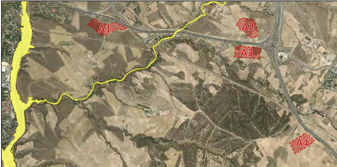
Riesgo de inundación – Avenida T=500 años (Fuente: SNCZI).
